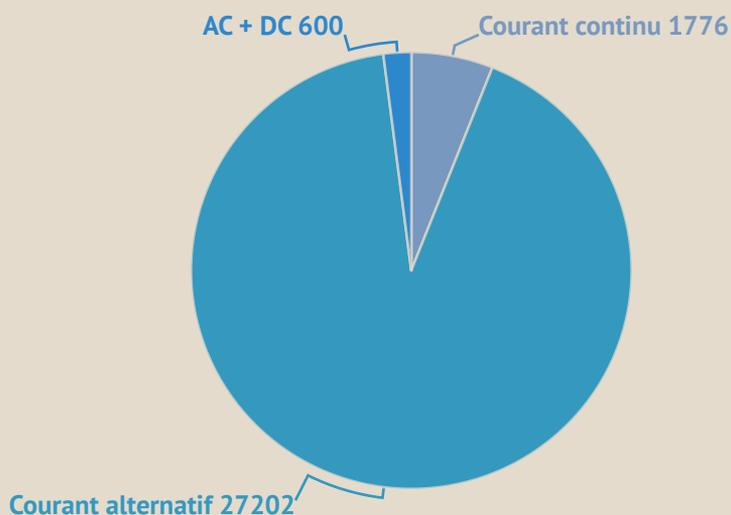
Une large majorité de points de recharge (92 %) est en courant alternatif et délivre principalement une puissance supérieure ou égale à 22 kW. En fonction de la puissance de ces points, les voitures électriques ne disposant pas d'un chargeur embarqué adapté ne peuvent pas bénéficier à tous les coups de la puissance de charge maximale offerte par ces derniers.
