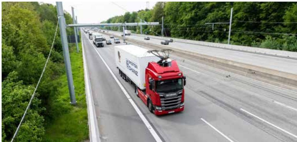
La solution “**conductive par le sol**”, avec sa piste d’alimentation au niveau du sol, est un bon compromis avec une intégration dans le sol plus simple et moins coûteuse que la solution “inductive”. Elle offre les mêmes avantages que la solution par caténares, mais sans ses inconvénients.
