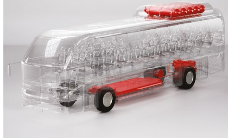
Figure 11 - Vue 3D de l'autocar électrique à hydrogène en développement dans le cadre du projet CoacHyfied (Source : CoacHyfied)
