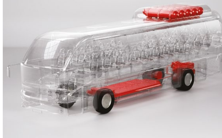
Figure 11 - Vue 3D de l'autocar électrique à hydrogène en développement dans le cadre du projet CoacHyfied (Source : CoacHyfied)
