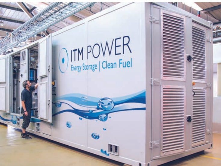
Electrolyseur PEM intégré à une station hydrogène
